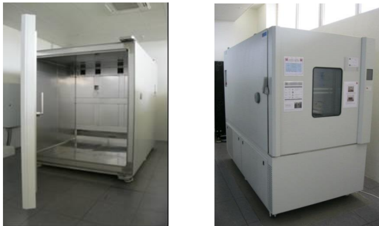
Figura 1. Cámaras climáticas Fitoclíma modelos 8000 ECP50 y 1500 ECP50.
